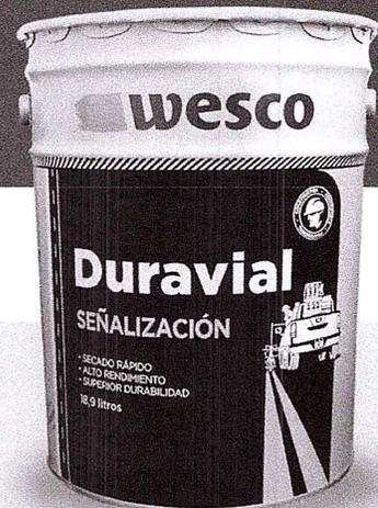
Excelente compatibilidad con esferas de vidrio que mejoran la visibilidad nocturna. Se recomienda la proporción de 1 litro de pintura aplicada con 1 kilo de micro esferas tipo "DROP ON".
