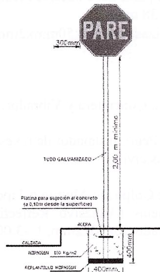
La señal debe quedar separada mínimo 30 cm desde el filo de la cuneta con una altura libre mínimo de 2.00 m, anclada sobre un dado de hormigón  $f'c=180\text{kg/cm}^2$  de  $40\times 40\times 40$  cm por cada tubo
